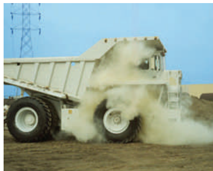
Disparo do sistema de supressão num veículo fora de estrada
